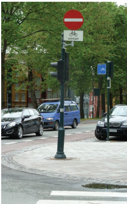
Figur 3.17: Sykling tillatt mot kjøreretningen i envegsregulert gate
