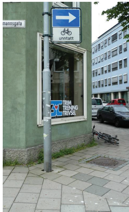
Figur 3.17: Sykling tillatt mot kjøreretningen i envegsregulert gate
