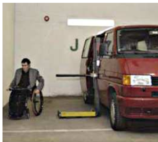
Illustrasjon fra Norges Handikapforbund. Sidemontert heis krever god bredde. Foto: Einar Aslaksen/ Norges Handikapforbund
