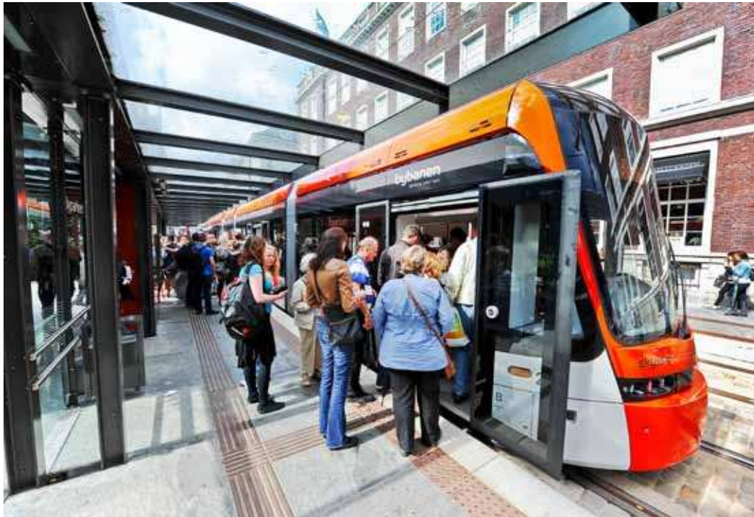
Holdeplass og transportmiddel er tilpasset hverandre og gir trinnfri atkomst. Kunstige ledelinjer markerer holdeplassen og gjør den enklere å finne for flere. Eksempelet viser Bybanen i Bergen Foto: Knut Opeide.
