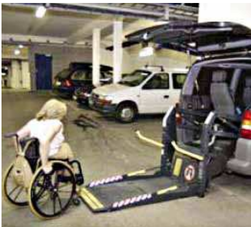
Illustrasjon fra Norges Handikapforbund. Bakmontert heis krever god plass bak bilen. Foto: Einar Aslaksen/ Norges Handikapforbund
