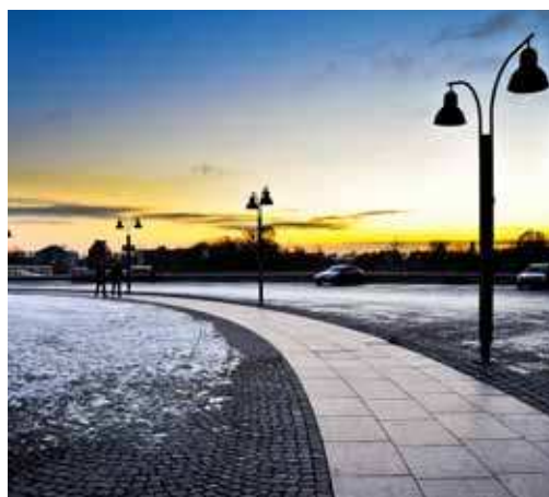
Tydlig avgrenset gangsoner er med på å forenkle trafikkbildet og lette orienteringen. Overgangen mellom materialene danner en naturlig ledelinje. Foto: Knut Opeide.
