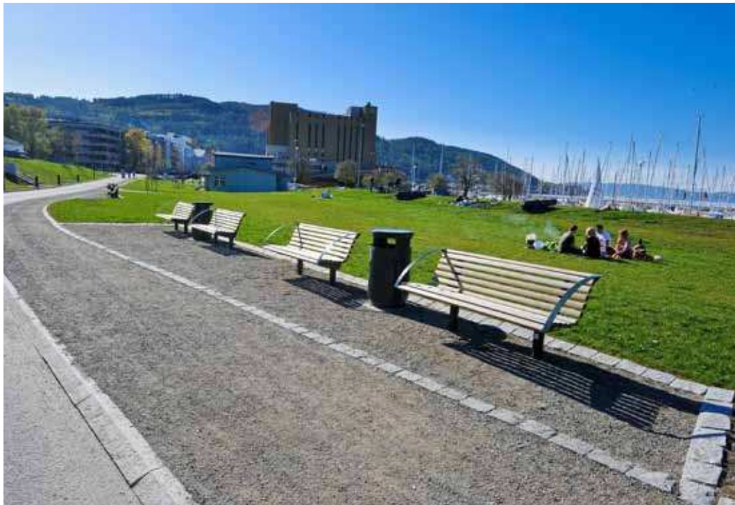
Turområde med universell utforming. Gangarealet har jevnt og slett underlag med tydelig avgrensning mot sidearealet. Det er etablert en naturlig ledelinje i overgangen gang- og sideareal. Benkene har armlener og ryggstøtte, og er plassert utenfor selve gangarealet. Foto: Knut Opeide.
