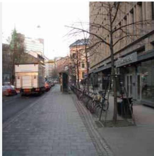
Pilestredet, Oslo. Her er en god løsning med sykler parkert bak holdeplassen og avskjermet med en tydelig stripe med gatestein som skiller seg fra den hellelagte bussholdeplassen. Foto: Finn Aslaksen.
