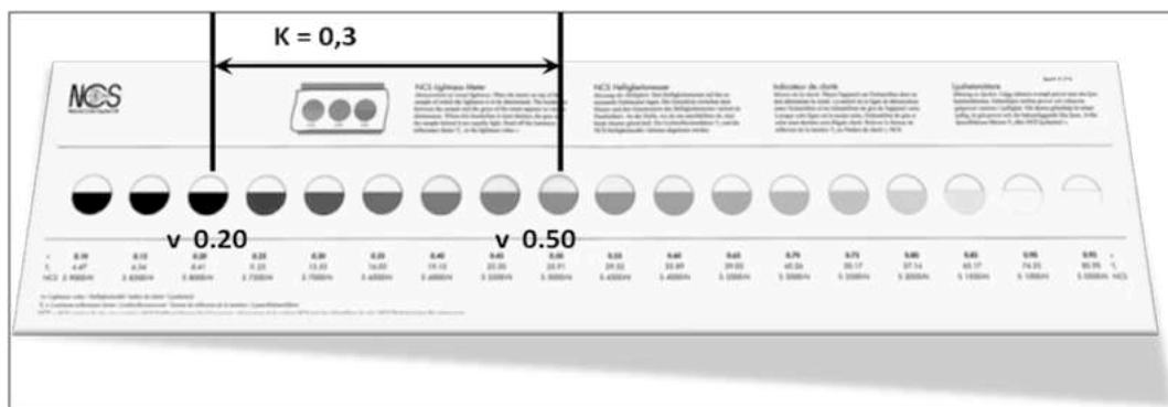
Med en lyshetsmåler kan en måle kontrasten mellom ulike overflater. K er lyshetskontrast og v er lyshetstall for de enkelte farger. Illustrasjonen viser NCS Lightness Meter (gjengitt med tillatelse fra NCS Colour Centre Norway (NCS- Natural Colourssystem ®)).
