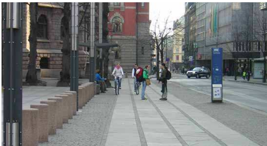
Akersgata, Oslo. Hellene er gode å gå på og avgrensningen mot gatestein gir en naturlig ledelinje. Pullertene og gatelysene som står på rekker utgjør også en slags naturlig visuell ledelinje som er med på å understreke retningen på gata. Det mangler ledelinje mot busstopp. Foto: Elin Katrine Nilsen.
