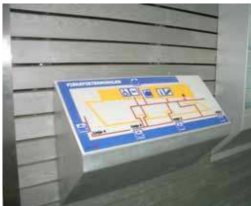
Fiskepirterminalen, Stavanger. Taktilt kart som gir oversikt over knutepunktet. Kartet har også god lesbarhet for seende og er et godt eksempel på universell utforming av denne type informasjon. Foto: Finn Aslaksen.
