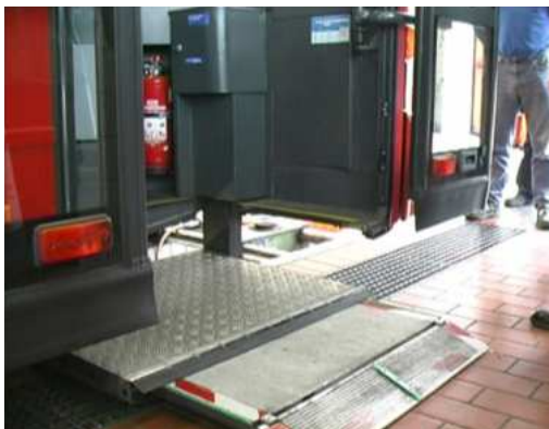
Bremen, Tyskland. Heis innebygget i gulvet i bussen. Foto: Finn Aslaksen.
