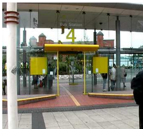
Liverpool, Storbritannia. Birkenhead Bus Station har tydelig markerte innganger og samtidig god markering av nivåsprang. Her er det ca 8 oppstillingsplasser for buss rundt et bygg. Det er glassvegger, og man ser fra alle deler av bygget når bussene stiller opp utenfor. Foto: Finn Aslaksen.
