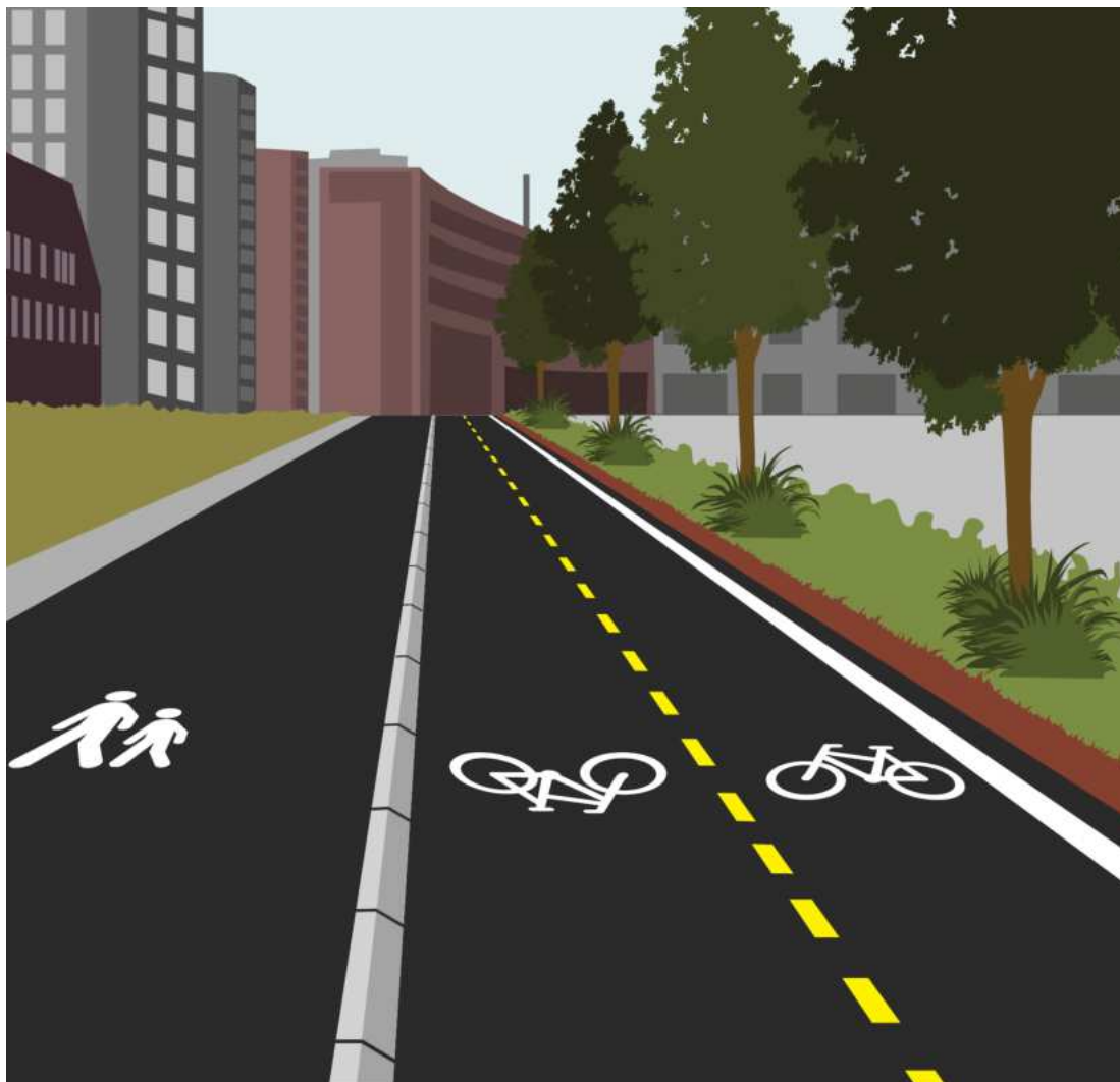
Figur 8.24 — 4 Eksempel på bruk av 1037 «Gangsymbol»
