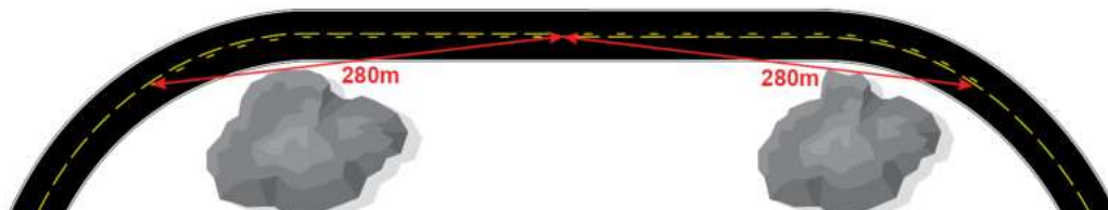
Figur 4.3 — Kombinasjonslinjer uten mellomliggende kjørefeltlinje
