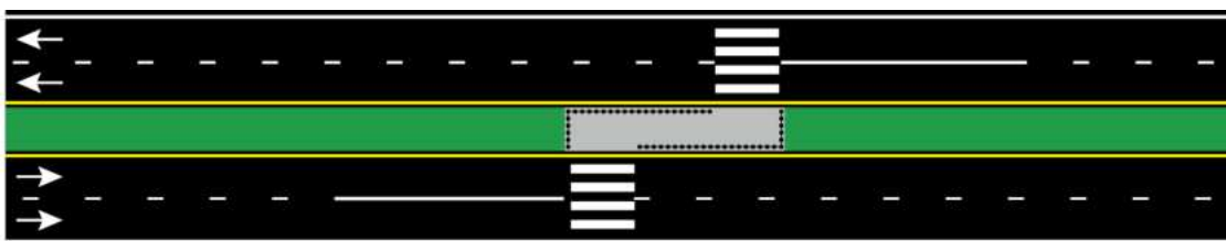
Figur 8.7 — Delelinje foran gangfelt på 4-feltsveg ved fartsgrense \leq 60 km/t
