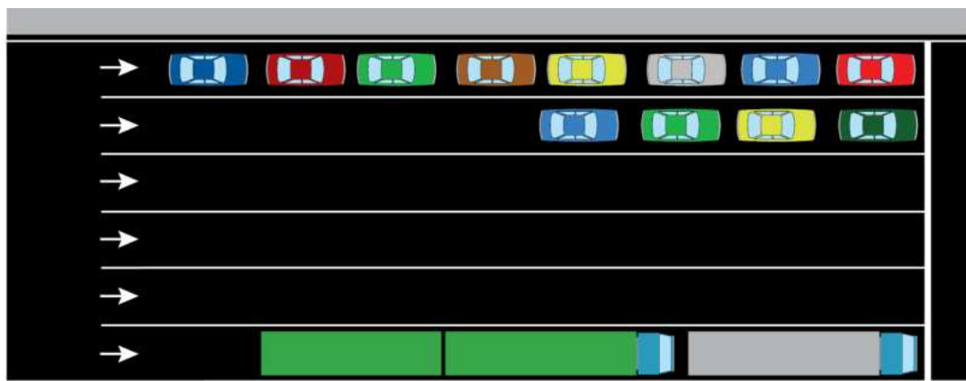
Figur 10.5 — Eksempel på oppmerking på ferjekaier
