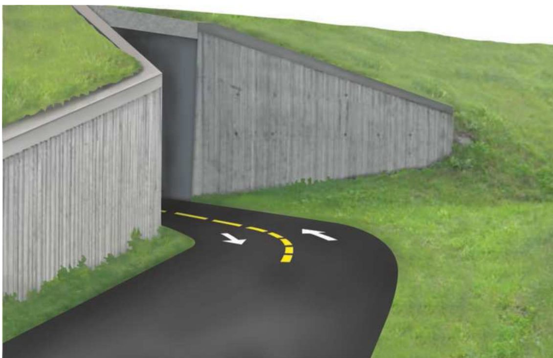
Figur 8.19 — Eksempel på bruk av midtlinje på gang- og sykkelveger
