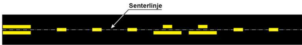
Figur 3.1 — 3-linje kompakt system for midtlinje
