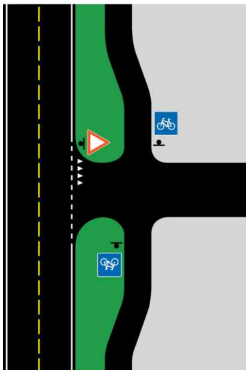
Figur 8.20 — Oppmerking når kjørende på sekundærveg ikke har vikeplikt for syklende (trafikkreglene § 7 nr. 4 annet ledd)
